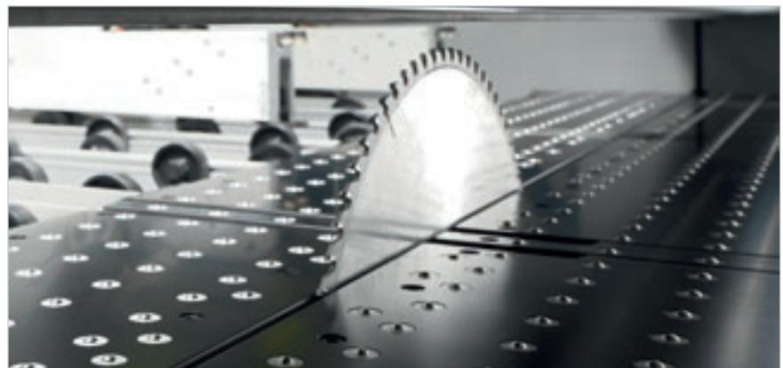
Maximale Qualität des Endprodukts dank des **als Luftkissentisch ausgestattetem Maschinenkörper** für die Handhabung empfindlicher Materialien. Diese Eigenschaft gestattet außerdem, die Fläche direkt neben dem Sägeblatt ständig sauber zu halten.
