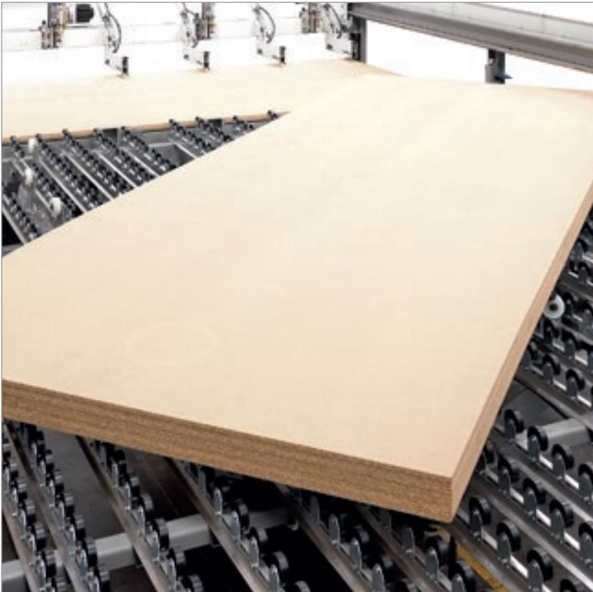
Drehstation für Kopfschnitte ist in der Lage die Platten ohne Reibung zu drehen. Die patentierte Konstruktionsbauart dreht die Platten immer zur Nulllinie, sowohl vor als auch nach der Drehung.
