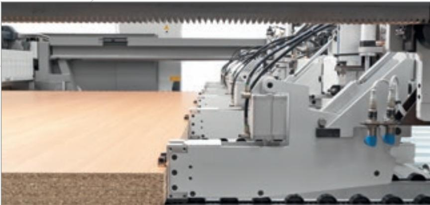
Die unabhängigen und selbstnivellierenden **Zangen** gewährleisten eine beständige Aufspannung des Plattenpakets. Ihr besonderer Aufbau und die Maschinenlogik gestatten den vollständigen Auswurf der aufgeteilten Plattenstapel vor die Schnittlinie. Auf diese Weise wird sowohl deren Handhabung als auch die Entnahme der Abschnitte erleichtert.
