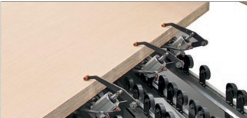
Spannvorrichtungen halten das Plattenpaket während der Drehung fest um ein Verrutschen auszuschließen.
