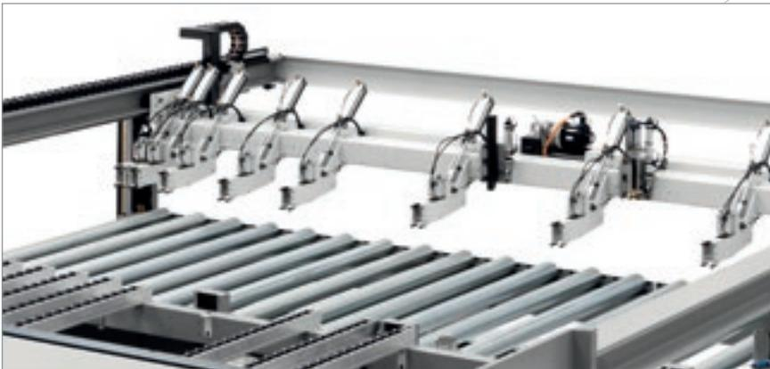
Präzise und schnelle Positionierung der Platten für höchste Schnittgenauigkeit dank des stabilen **Schiebers**, der durch einen Brushless-Motor angetrieben wird. Die Gleitfläche unterhalb des Schiebers ist mit unabhängigen freilaufenden Rollen ausgestattet, um Abdrücke auf Platten mit empfindlichen Oberflächen zu vermeiden.
