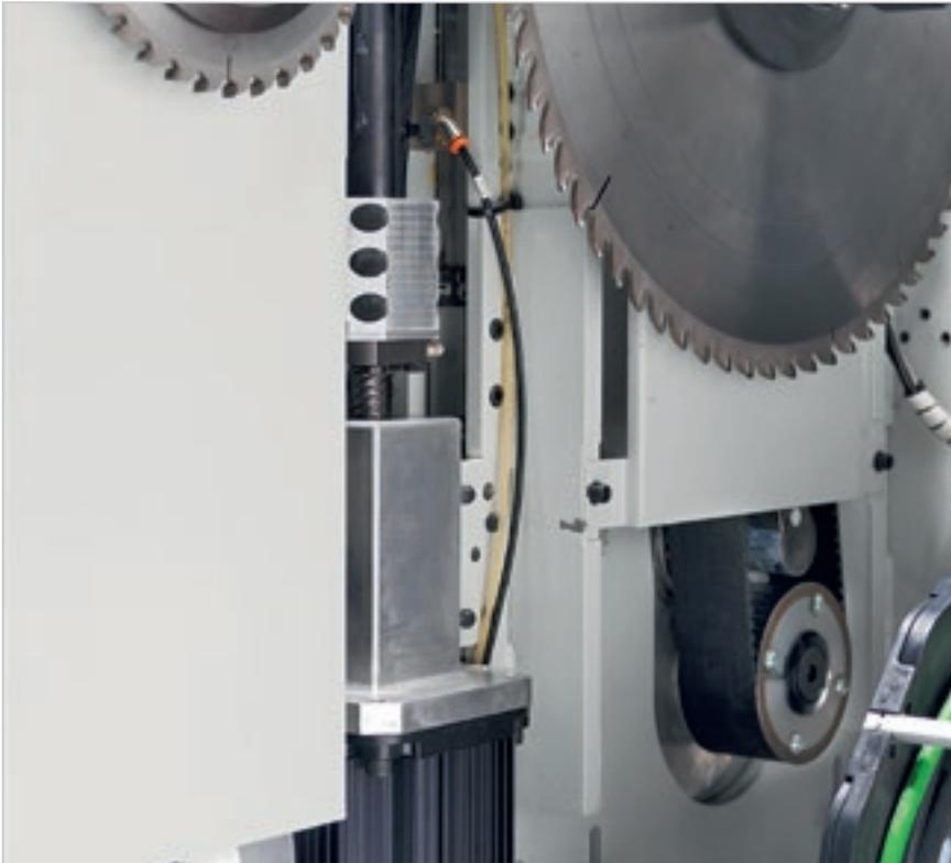
Das **Anheben der Sägeblätter** wird durch einen Brushless-Motor und ein System mit Kugelumlaufspindel gesteuert. Dieses System stellt eine präzise und schnelle Einstellung des Sägeblattüberstandes sicher.
