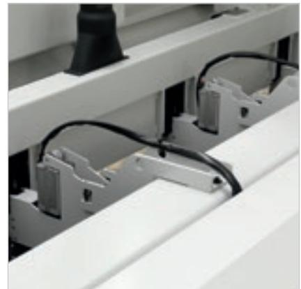
Der gleichmäßige und kontrollierte Druck auf das zu schneidende Plattenpaket wird durch die **Andrückvorrichtung** mit Einzelelementaufbau gewährleistet.
