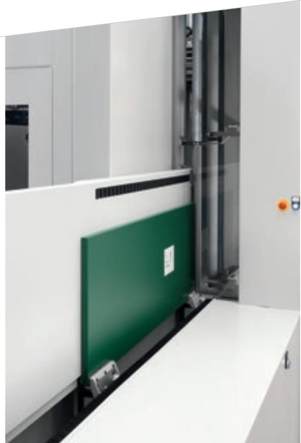
Zudem sind die **Zangen** mit einem System zum Vermessen der Dicke der Platte ausgestattet, wodurch sich der Wert des Programms in Echtzeit ändern lässt. Damit ist die Präzision für die auf die Achse „Z“ bezogenen Bearbeitungen gewährleistet.
