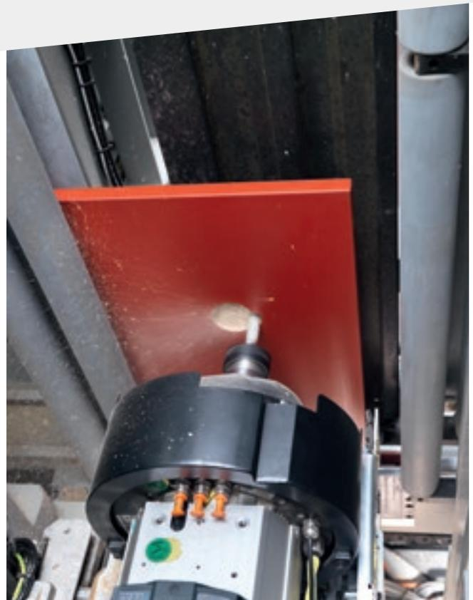
Pantographfräsmaschine mit integrierter C-Achse (Option).
