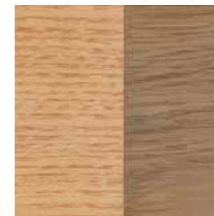
Stumpfe Verbindung mit dichter Fuge, von der ZU Stumpf 330 F-P mit Winkelschnittmessern. Nur für Fixlängen wie z.B. Furnierparkett oder Möbelfronten.
