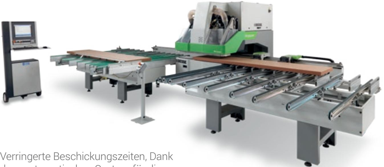
Verringerte Beschickungszeiten, Dank dem automatischen System für die Werkstückpositionierung durch welches die Platten automatisch zum Anschlagpunkt gebracht werden.
