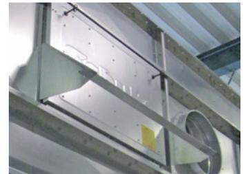
**6 Explosionstüren mit Flammfront-Abweisern** ermöglichen eine direkte Druckentlastung. Höchste Sicherheit bieten zusätzlich eingebaute Sicherheitspositionsendschalter zur Anlagenüberwachung und Notabschaltung.
