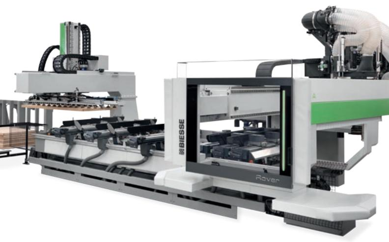
Synchro kann durch die Bezugsvorrichtung des Stapels und den Vorfluchtungszyklus der Platte, der in verdeckter Zeit während das Rover Arbeitszentrum die vorherige Platte bearbeitet, durchgeführt wird, Stapeln mit unterschiedlich großen Platten bearbeiten.
