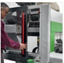
Vereinfachter Zugang während der Bestückung dank der Fronthaube, die geöffnet werden kann.
