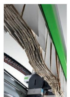
**Seitlicher Schutzbänder** zum Schutz der Arbeitsgruppe, mobil, um mit maximaler Geschwindigkeit in vollkommener Sicherheit zu arbeiten.
