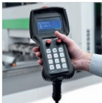
Fernbedienung für eine direkte und sofortige Kontrolle durch den Bediener.
