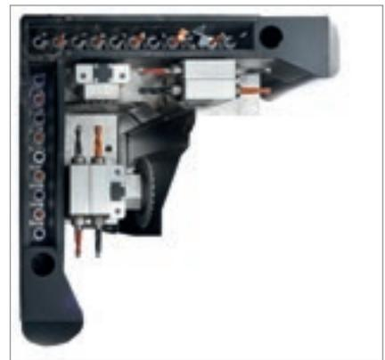
Der neue Bohrkopf BH 30 2L ist mit einer automatischen Schmierung und Absaugung aus Metall für eine längere Lebensdauer ausgestattet. Er ist flüssigkeitsgekühlt, um höchste Präzision zu gewährleisten.
