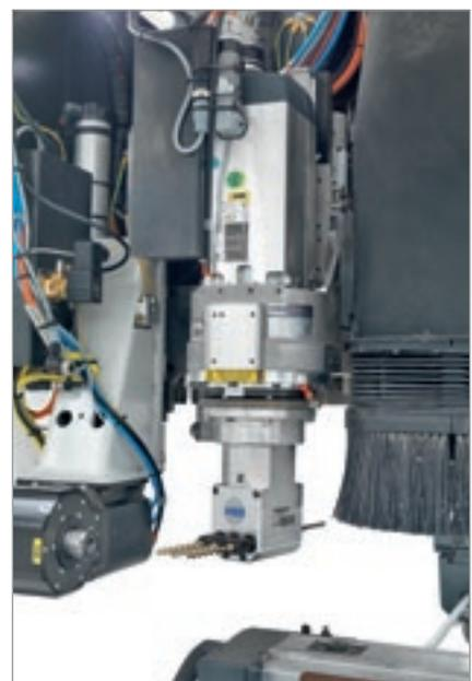
Die Multifunktionseinheit, die stufenlos über die CNC 360° positionierbar ist, kann Aggregate für die Durchführung spezifischer Bearbeitungen aufnehmen (Schlosskasten, Sitze für Scharniere, horizontale Tiefbohrung, Kappen usw).
