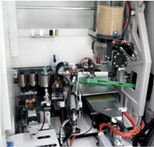
Anleimaggregat für die automatische Anbringung von Rollen- oder Streifenkanten von 0,4 bis 12 mm.
