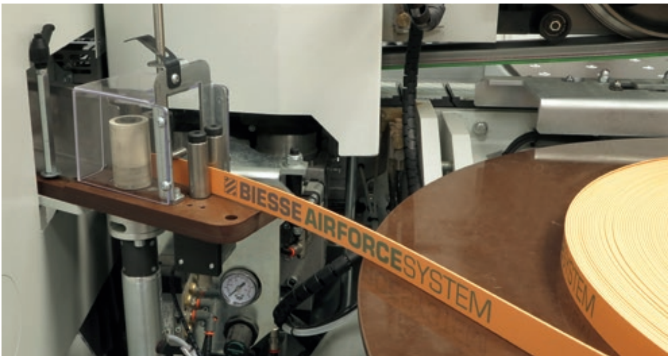
Automatische Zuführung über Einzelrolle, ermöglicht den schnellen Kantenwechsel ohne Öffnen der Kabinen. Optischer Sensor zum Erkennen der richtigen Positionierung der Kante (opt.).
