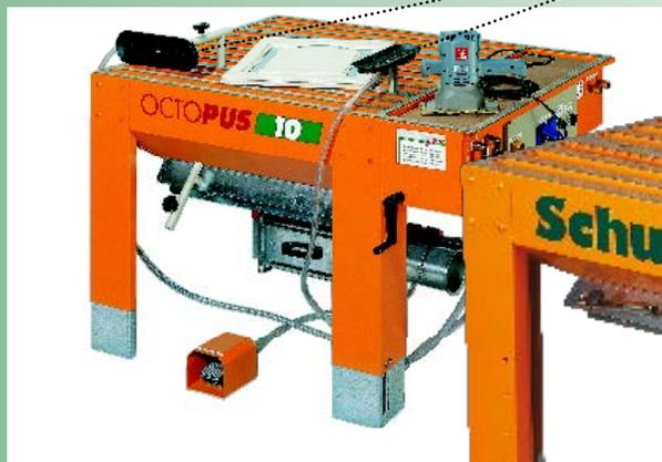
Vakuumspanner zur einfachen Befestigung der zu schleifenden Produkte
