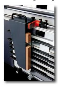
Der stabile, klappbare Längenanschlag (mit Feineinstellung) wird auf einer 30 mm massiven Rundstange geführt.
