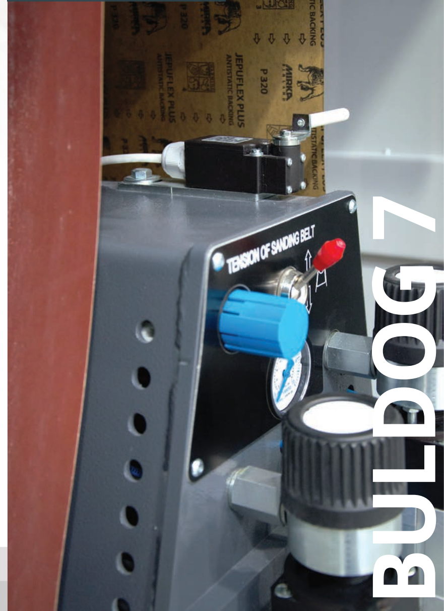
spannung und kontrolle der spannrolle
