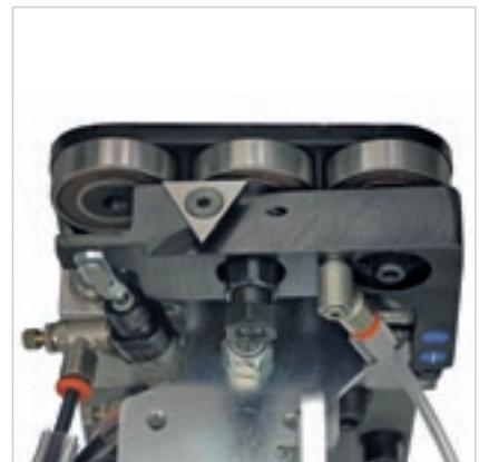
Das **Flachziehklingenaggregat**, das den Leim-überschuss am oberen und unteren Plattenteil entfernt, ist einzigartig am Markt. Es ist mit 4 Pneumatikzylindern für höchste Feinbearbeitungsqualität ausgestattet.
